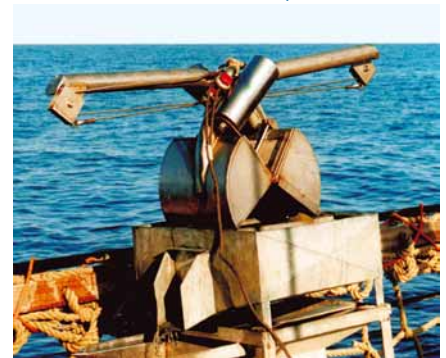
Van-Veen-Greifer für die Bodenprobenahme
